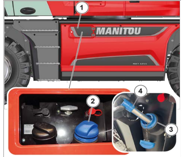
Afbeelding 226: Het filter van de vulopening van het DEF-reservoir controleren en reinigen
