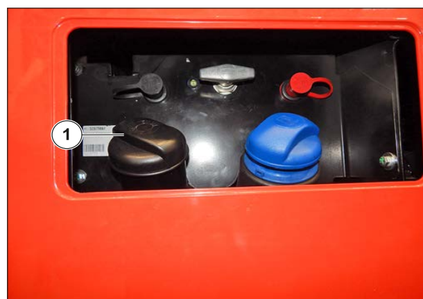
Afbeelding 121: De brandstoftank vullen
