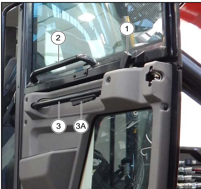
Afbeelding 59: De deur en de deurruit openen
