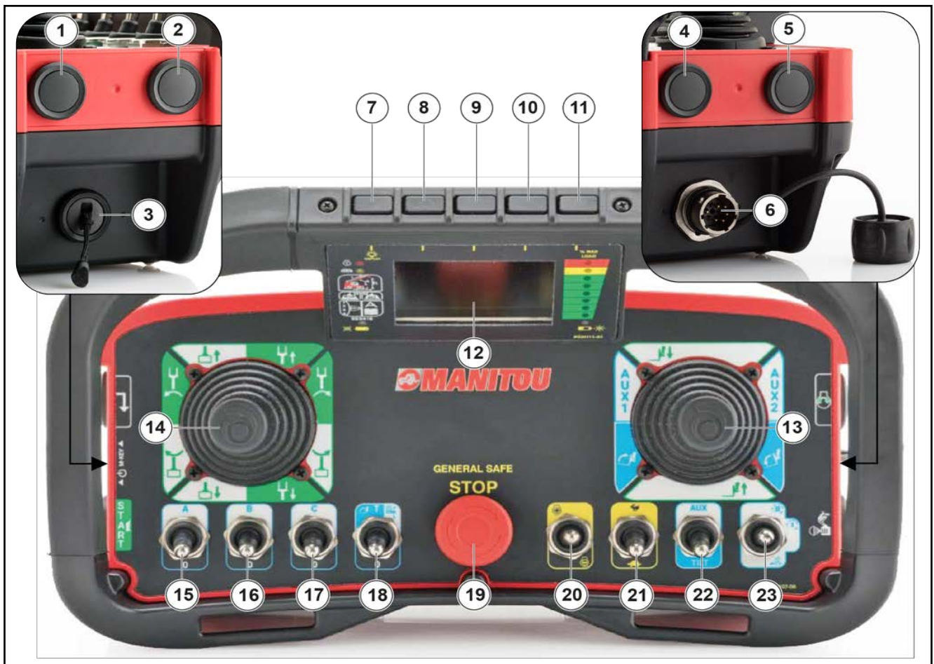
Afbeelding 110: Druktoetsenpaneel van de zender
